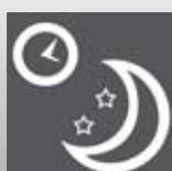
**Funktion "sleep":** Der Backofen schaltet sich nach einer einstellbaren Zeit, in der er nicht verwendet wird, selbst aus und trägt so zur Einsparung von Energiekosten bei.
