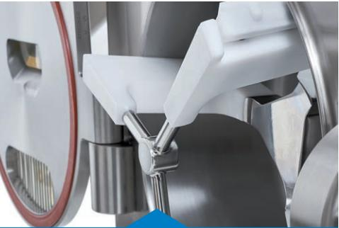
Agitateur POM impénétrable au froid et à la chaleur pour permettre l'**extraction intégrale de la glace et des crèmes** ; il est muni de racleurs auto-réglables pour un rendement constant du cylindre.
