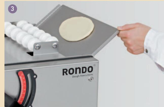
3. Nun drehen Sie das ovale Teigstück um 90° und kippen das Beschickungsblech. Die Walzen werden gleichzeitig automatisch auf die vorgewählte Dicke für den zweiten Durchgang eingestellt und der Teig wird nochmals ausgerollt.
