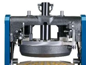
Die Teilvorrichtung arbeitet mit geringem Druck und schont so den Teig. Es ist kein manuelles Eingreifen des Bedieners erforderlich.
