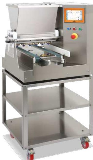
Babydrop pour des pâtes plus fermes. En option avec pompe pour pâtes plus liquides et crémeuses.
