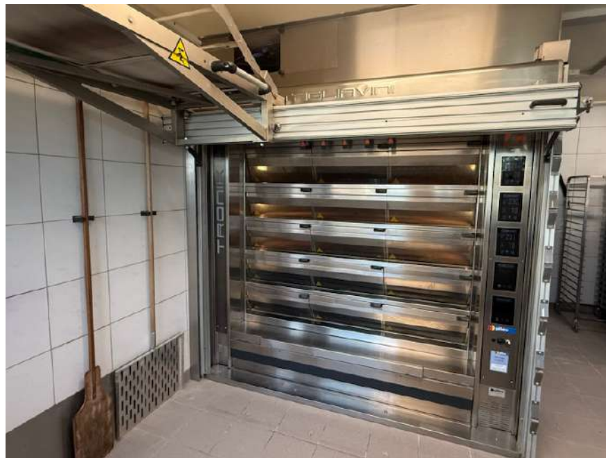
Le nouveau four à étages avec commande Tronik garantit une température précise, des résultats constants et une efficacité énergétique maximale.
